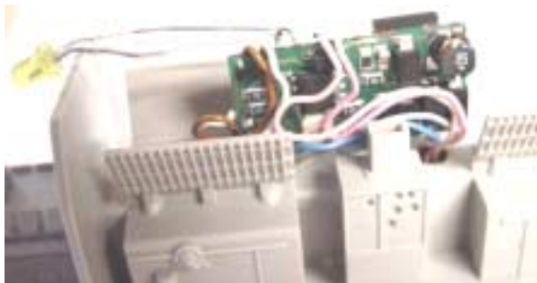
Gelbe 15V-LED als Zusatzfunktion 1 - Maschinenraumlicht am Decoder angelötet.
