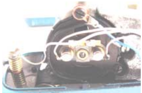
Gelbe 15V-LED als Zusatzfunktion 1 - Maschinenraumlicht am Decoder angelötet.
