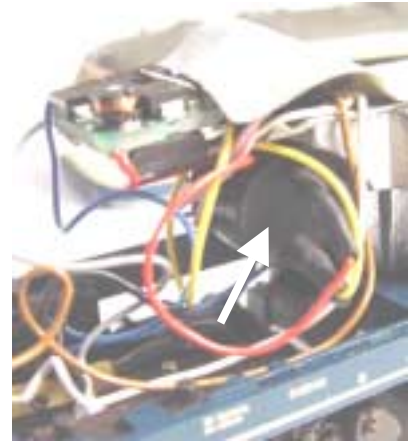
12V-Piezo als Lokpfeife am gelben und roten Decoder- draht (Pfeil)
