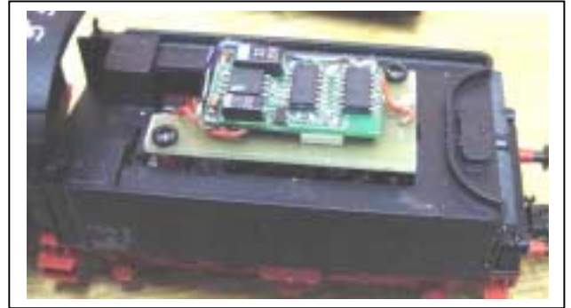
BR55: Decoder im Tender unter den "Kohlen" eingebaut
